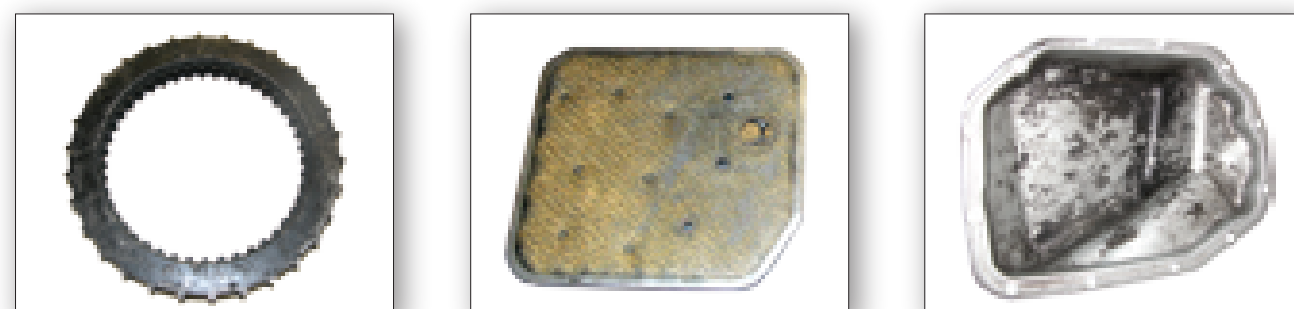
▲ Обгоревший диск сцепления ▲ Фильтр, забитый отложениями ▲ Масляные отложения в поддоне
